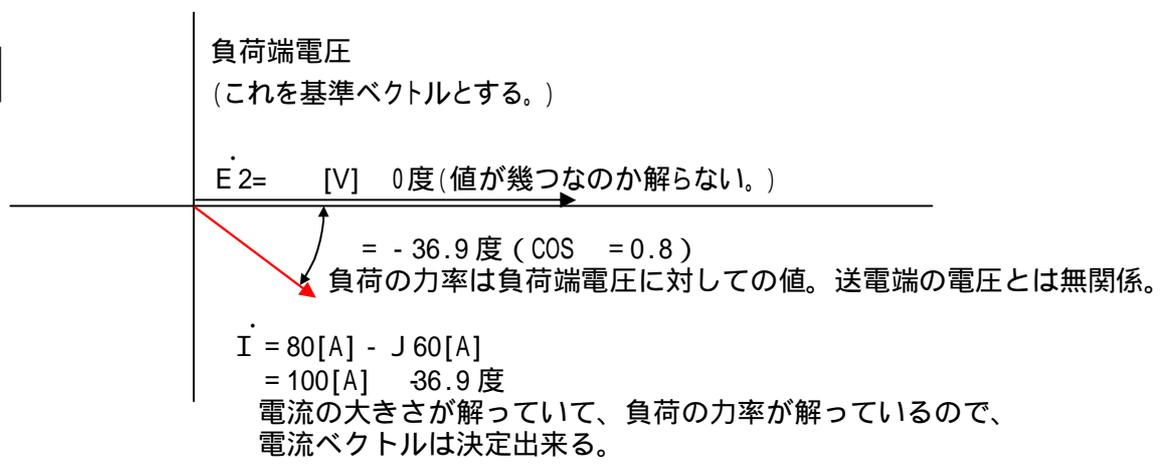
このベクトル図に電源電圧のベクトルと、配線の電圧降下のベクトルを加筆すると下図になります。
